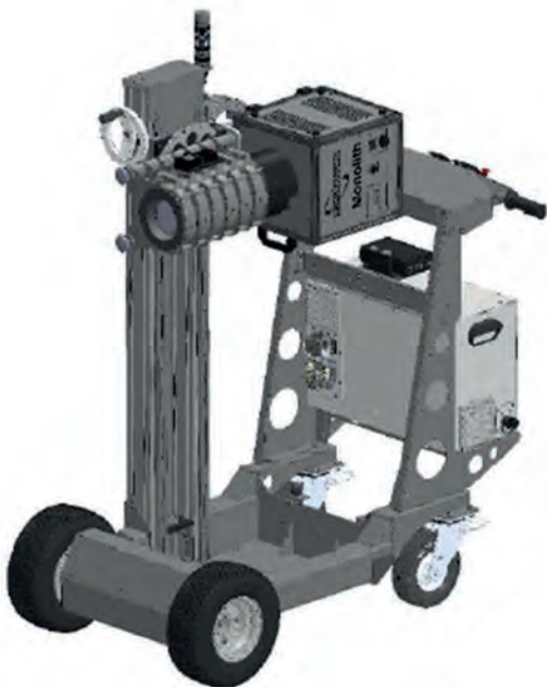
Figura 18 Immagine del carrello motorizzato impiegato per la movimentazione del sistema di misura HPGe
