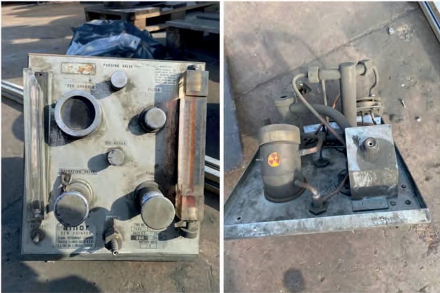
Figura 8. Il pannello frontale del misuratore della temperatura di rugiada contenente Radio-226 rinvenuto presso un centro recupero metalli. A sinistra, vista frontale; a destra, vista superiore in cui è visibile la camera a nebbia contenente la sorgente radioattiva.
