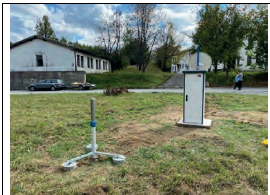
Immagine: Monitor aerosol fisso installato su cemento con sonda Gamma Dose Rate
