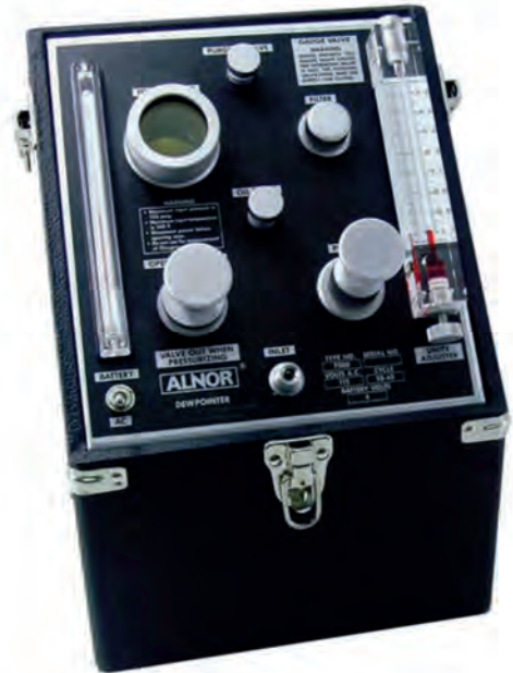
Figura 7. A sinistra, etichetta ufficiale e norme interne di radioprotezione del misuratore della temperatura di rugiada. A destra, lo strumento ALNOR DEW POINTER 7000.
