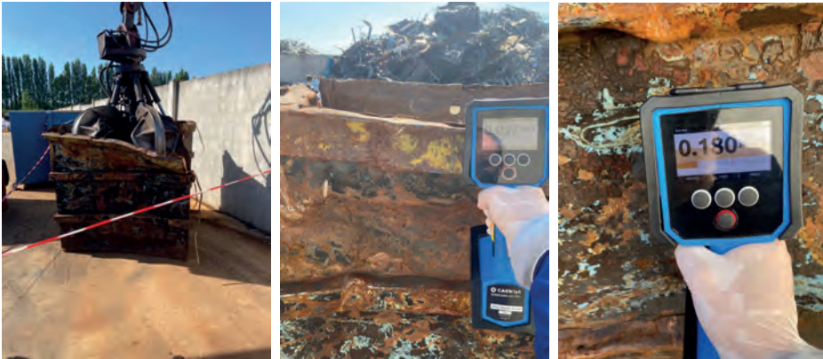
Figura 9. Operazioni di ricerca svolte dall'Esperto di Radioprotezione, nel caso specifico mediante utilizzo del monitor portatile RADHAND® 600 PRO (prodotto da CAEN S.p.A.), consentendo congiuntamente misurazioni di rateo di dose e spettrometriche grazie al rivelatore a scintillazione 51x51 mm (2"x2") NaI(Tl). Il rivelatore è inoltre dotato di tecnologia RFID UHF per un facile tracciamento degli elementi misurati.
