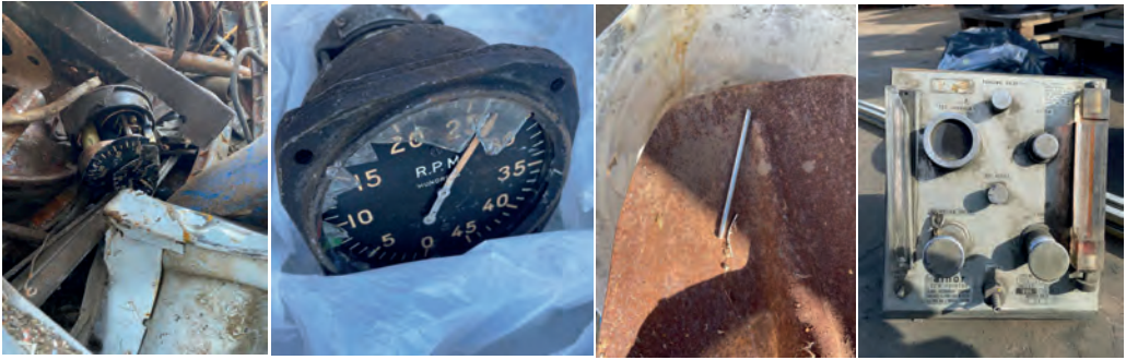
Figura 6. Alcuni esempi di sorgenti ritrovate tra i rottami. Da sinistra verso destra, due quadranti, una barra di metallo radioattiva, una camera a nebbia per la misurazione della temperatura di rugiada.
